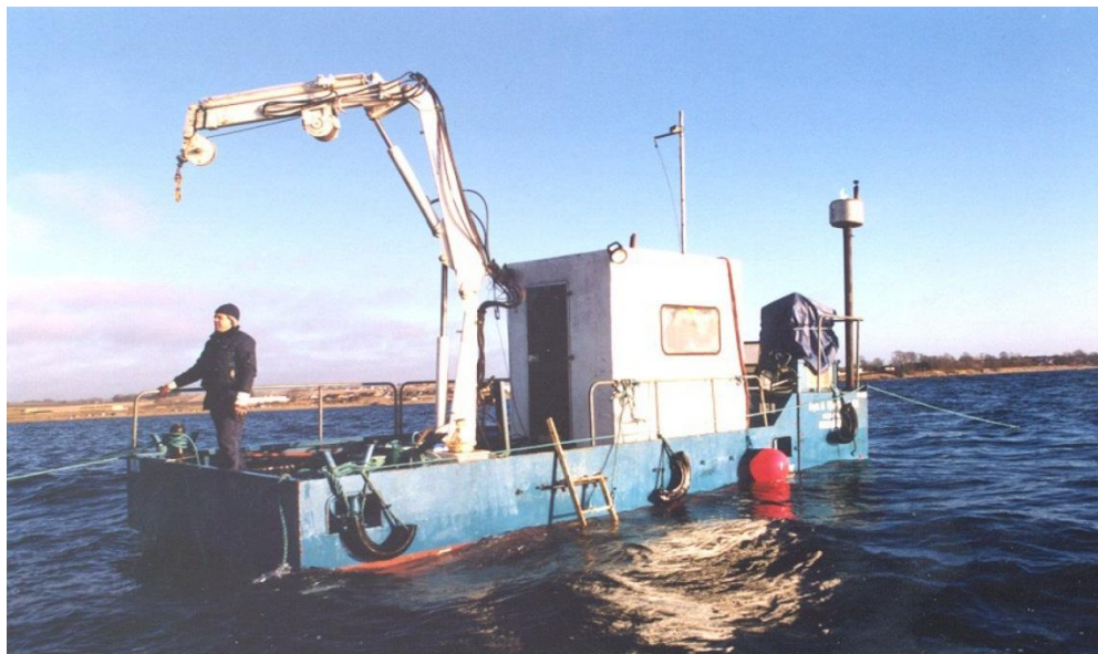
Figur 14, Arbetspråm för mindre lyft.
