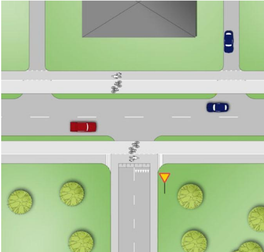
Figur 15. Principutformning genomgående gång- och cykelbana i korsningspunkt (Bild från SATSA II Regional cykelplan för Stockholms län)
