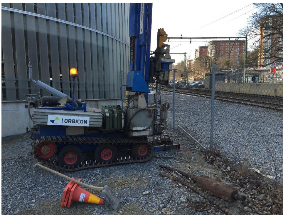
Foto 3. Borring av provpunkt BH7 söder om spårområdet. Halter av metaller har påträffats över Naturvårdsverkets riktvärden för KM mellan 0,5-2,0 m.u.my. Borring utfördes ner till 2,55 m.u.my då borrstopp erhöles.
