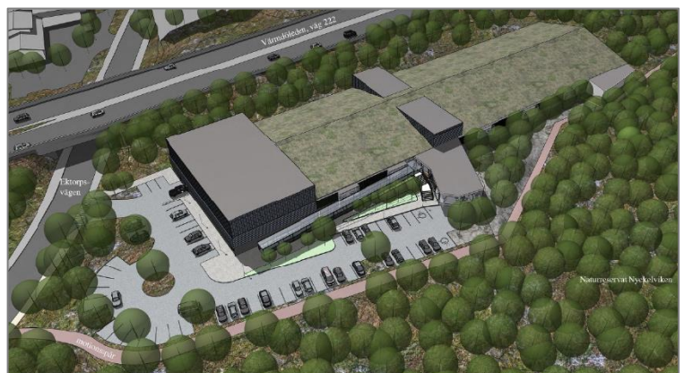
Figur 2, Planskiss på hallbyggnad, övre bilden visar utformning med växtbaserat bågformat tak, nedre bilden visar utformning med växtbaserat sadeltak. gvs arkitekter på uppdrag av Saltsjö Duvnäs Tennisklubb, 2016.
