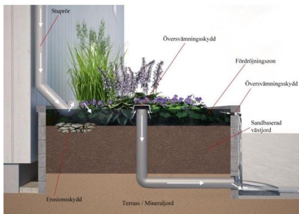
Figur 7. Exempel på växtbädd för omhändertagande av takvatten.
