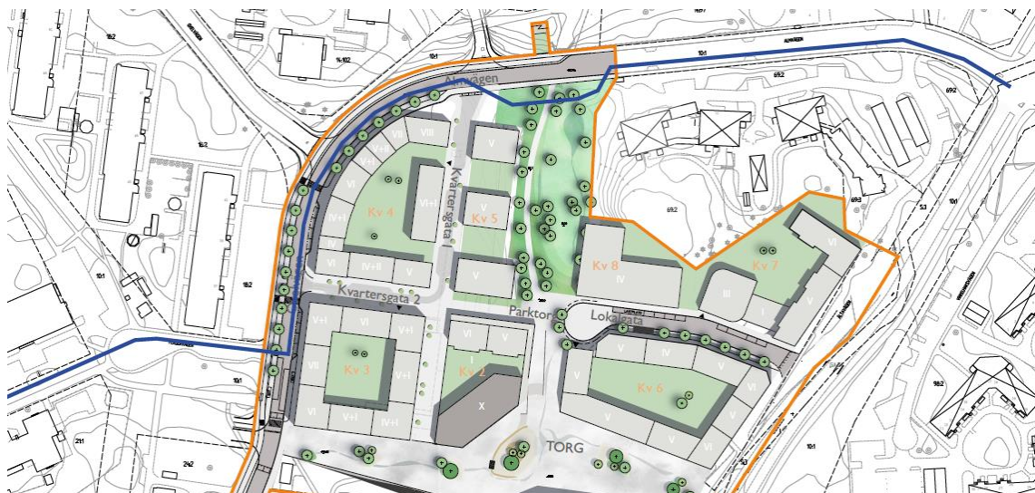
Figur 1: Översiktlig skiss som visar den tilltänkta omläggningen för huvudvattenledningen – det blåa strecket.
