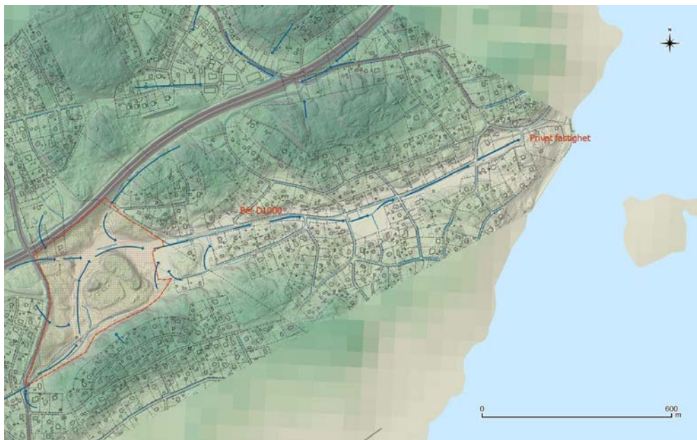
Figur 14. Befintlig avledning ned mot Baggensfjärden via diken, trummor och ledning under privat fastighet.
