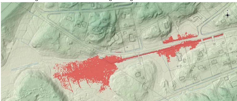
Figur 7. +17,5 är den nivå till vilken vatten kan stiga i dagsläget innan problem kan förväntas uppstå vid lägst belägna byggnaden.
