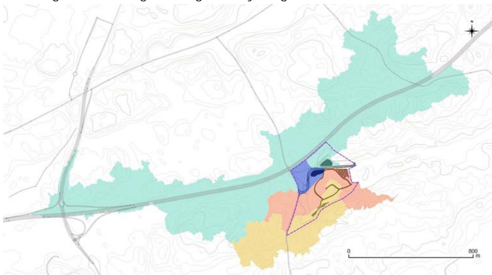
Figur 21. Avrinningsområdets fördelning till damm A (grönt), direkt till damm B (blått), till våtmarken vid skolan (gult) samt direkt till våtmarken vid förskolan (orange). Förutom ett litet vitt område som går till dike norr om den nya vägen leds allt vatten som kommer in till planområdet via våtmarken vid förskolan där flödesreglering föreslås.
