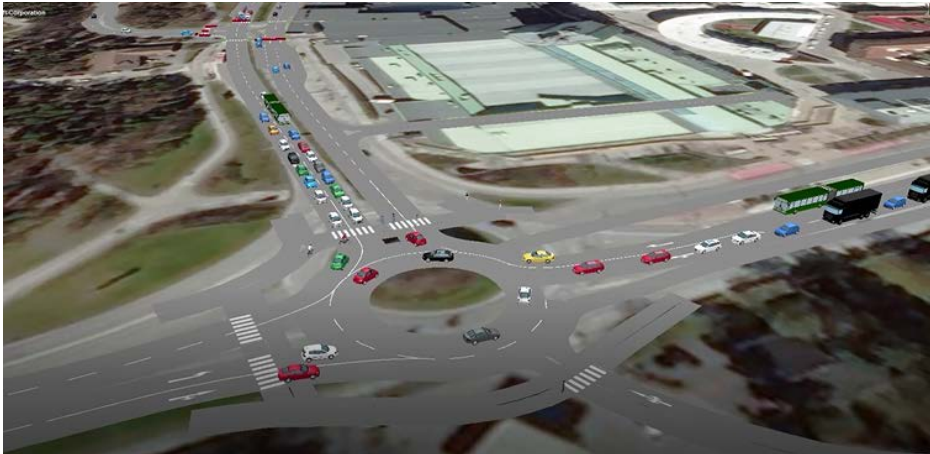
Figur 25. Illustration över simulering av trafik under byggtid för projekt "Nya gatan" i hörnan Vikdalsvägen/Värmdövägen mitt emot Nacka Forum.
