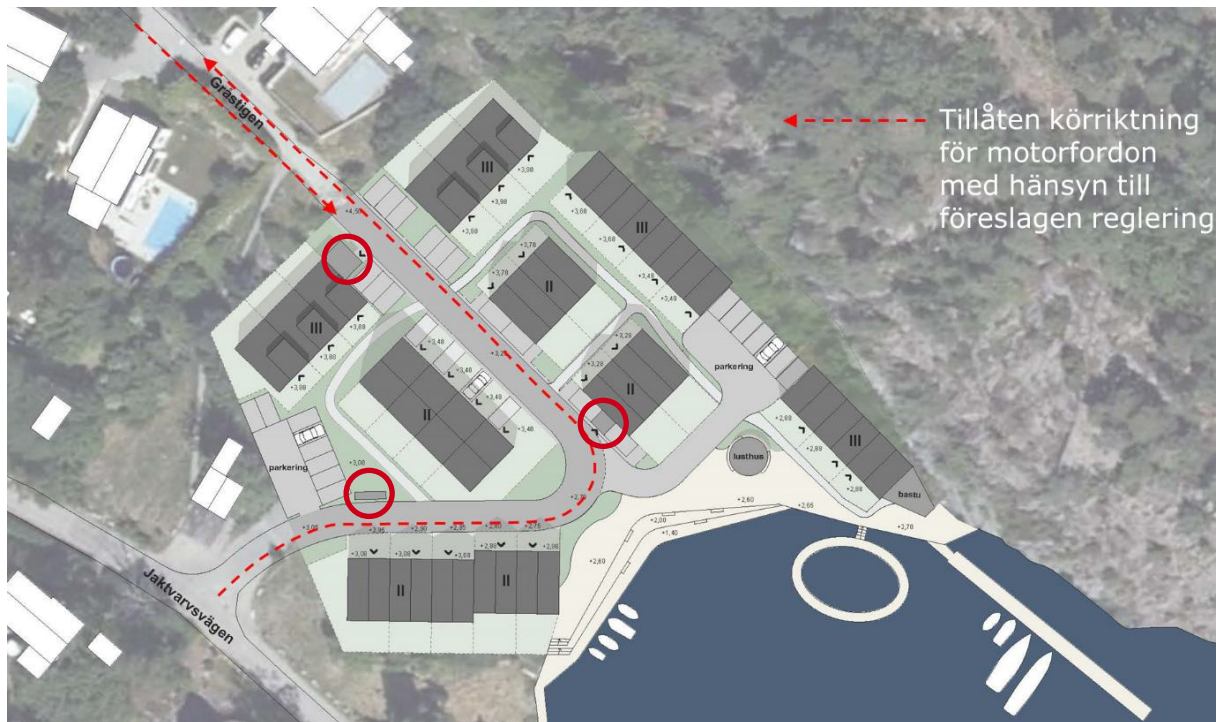
Figur 13, föreslagen körriktning med hänsyn till föreslagen reglering. Anfallsstationerna är markerad med röd ring.
