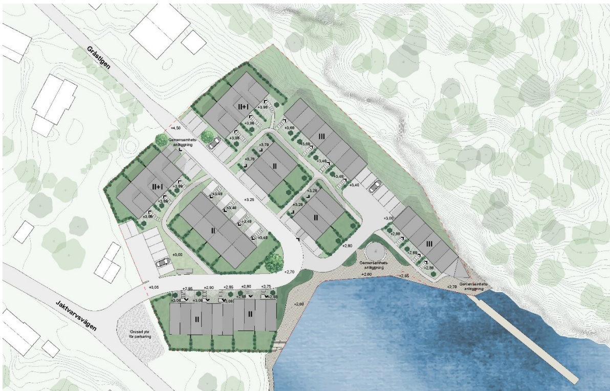
Figur 6. Övergripande situationsplan för planområdet, föreslagna nya byggnader i mörkgrått, ljusgrå yta illustrerar den nya gatan. Illustration framtagen av CJ Studio.
