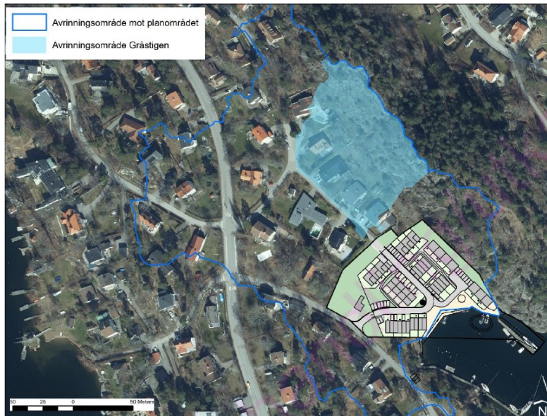
Figur 21. Avrinningsområde mot Gråstigen i förhållande till avrinningsområde mot planområdet. Avrinning mot Gråstigen kan omledas mot havet direkt istället för att belasta lågpunkten vid pumpstationen som det gör idag. Föreslagen höjdsättning och avvattnings innebär också att dagvatten och skyfall leds bort från lågpunkten. Sammantaget bedöms översvämningsrisken för pumpstation, transformatorstation samt Jaktvarvsvägen därmed kunna byggas bort.
