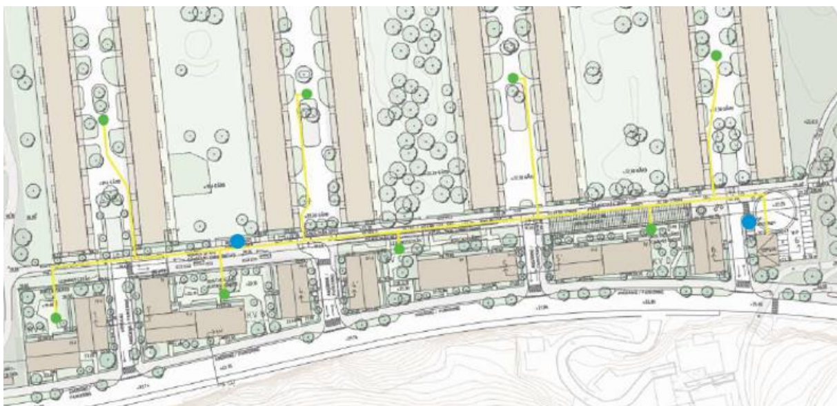
Figur 28. Illustrationen visar planerad avfallshantering inom planområdet efter genomförandet av detaljplanen. Ledningar för sopsugsanläggning illustrerat i gult, och placering av sopsugsnedkast i grönt. Blå markering visar behållare för källsortering av förpackningar.
