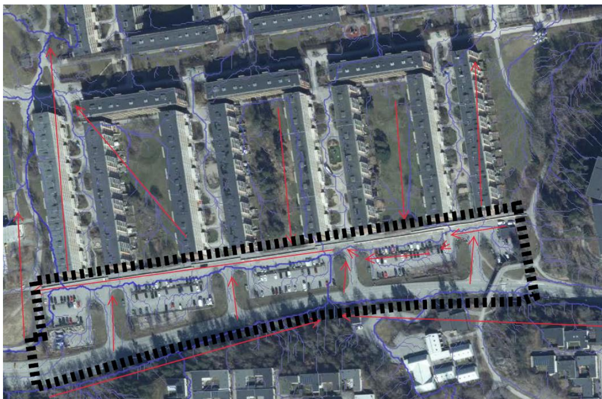
Figur 5. Befintlig avrinning enligt Scalgo. Rinnvägar förstärkt med röda pilar.
