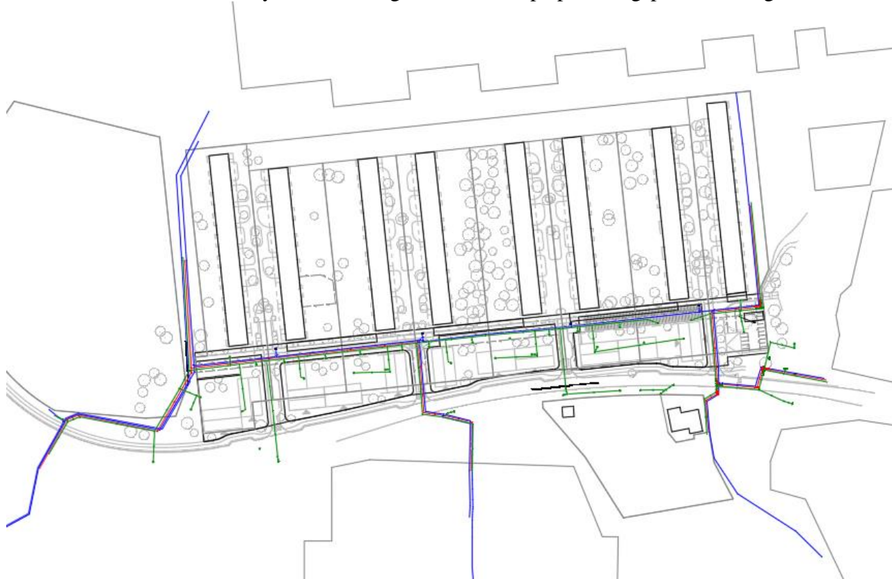
Figur 4. Va-ledningar i området, Underlag från Nacka Vatten.
