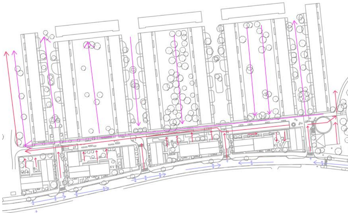
Figur 24. Avrinningsplan vid skyfall, markens höjdsätts så att avrinningen förståttningsvis leds västerut.
