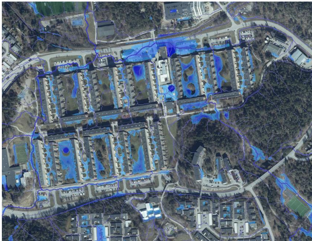
Figur 8. Ytor som blir översvämmade vid ett 100-årsregn under 12 timmar motsvarande 100 mm regn.
