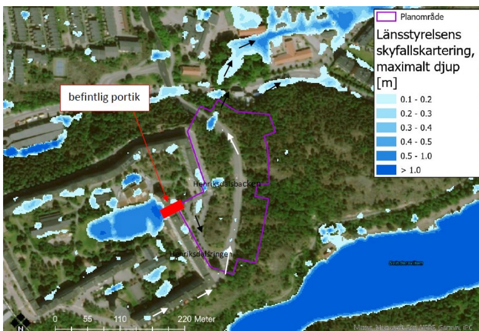
Figur 35. Skyfallsituation för befintliga förhållanden enligt Länsstyrelsens skyfallskartering (Länsstyrelsen Stockholms Län, 2021) Svarta och vita pilar visar flödesriktning. Röd ruta visar portik i befintlig bebyggelse.
