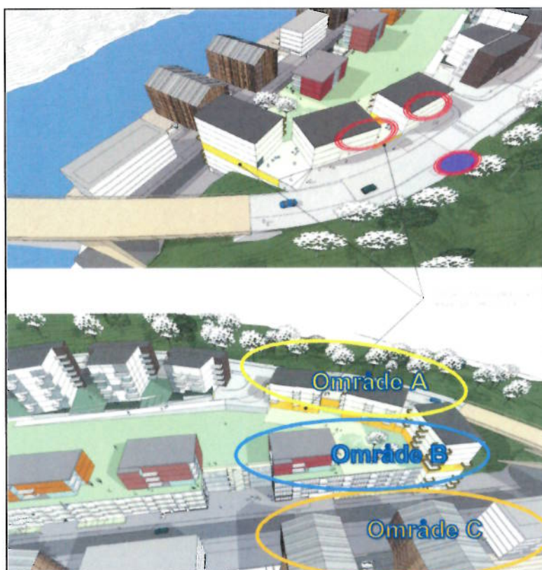
Figur 1. Schematisk avbildning av föreslagna byggnader. Röda ellipser visar läge för de f.d. cisternerna, lila ellips visar läge för f.d. cistern för lagring av tetrakloreten, den gula våningen är den sammanhängande bottenvåningen. Läget för de olika åtgärdsområdena A-C.
