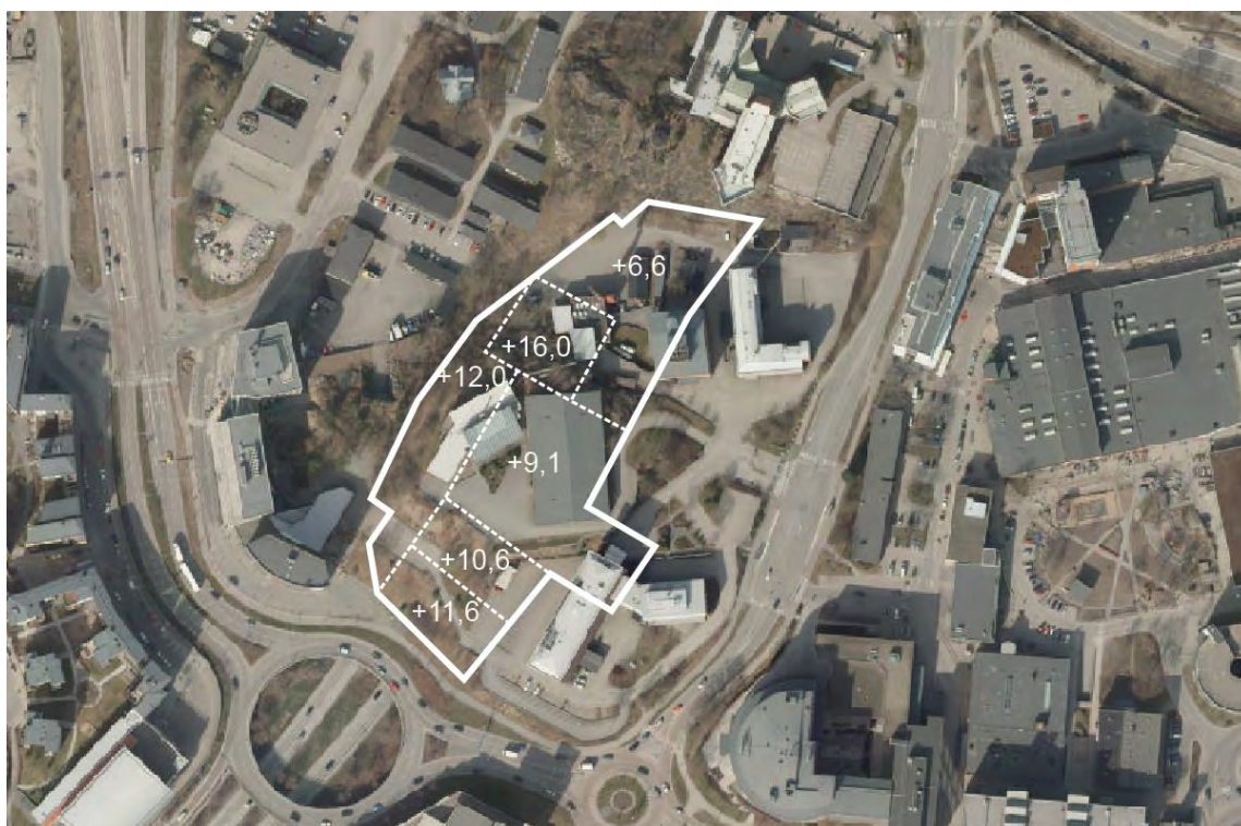
Aktuella begränsningar i meter över havet, för schaktning och andra ingrepp, med hänsyn till vägtunnlar.
