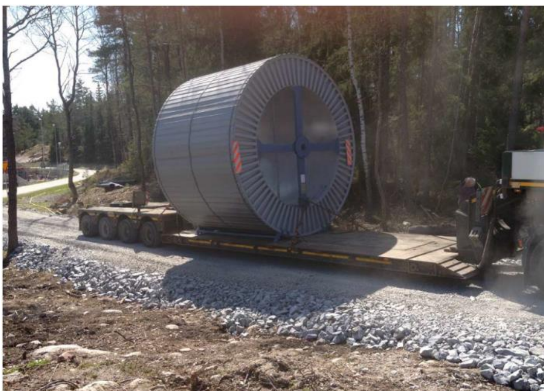
Figur 8. Exempel på transportekipage av kabeltrumma. Foto: FRECC
