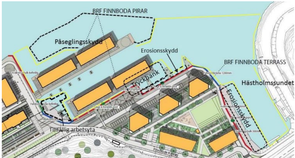
Figur 9. Schematisk bild över påseglingsskyddet, tryckbanken, den tillfälliga arbetsytan samt erosionsskyddens placering. Bedömd utbredning av förorenade sediment är inringat med gult sträck och sträcker sig utanför plangränsen.
