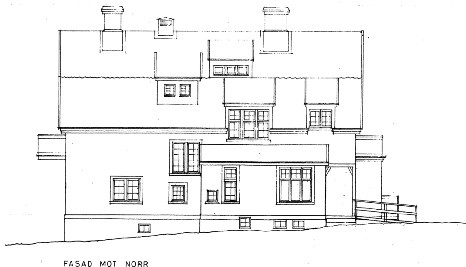
Figur 9. Fasadritning, 1983 med tillägg av takkupa vid taknock.
