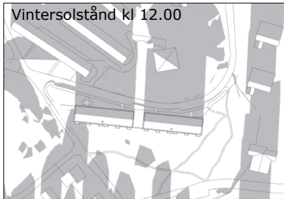
Figur 14: Solstudie för nya bostäders påverkan på befintliga bostäder. Fullständig solstudie finns i gestaltungsprogrammet. Illustration: Bergkrantz arkitektur
