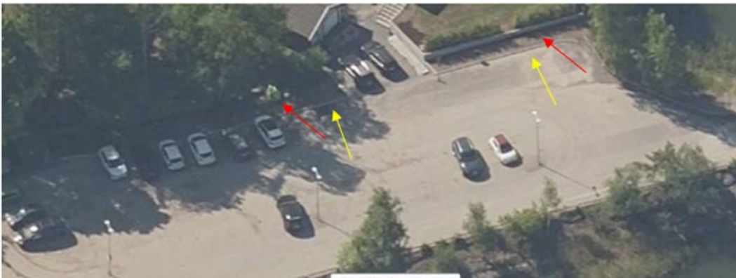
MapSpace 23 maj 2018. Kantstöd har tillkommit, se gula pilar. Ytan som har grävts upp och fyllts igen, se röda pilar.
