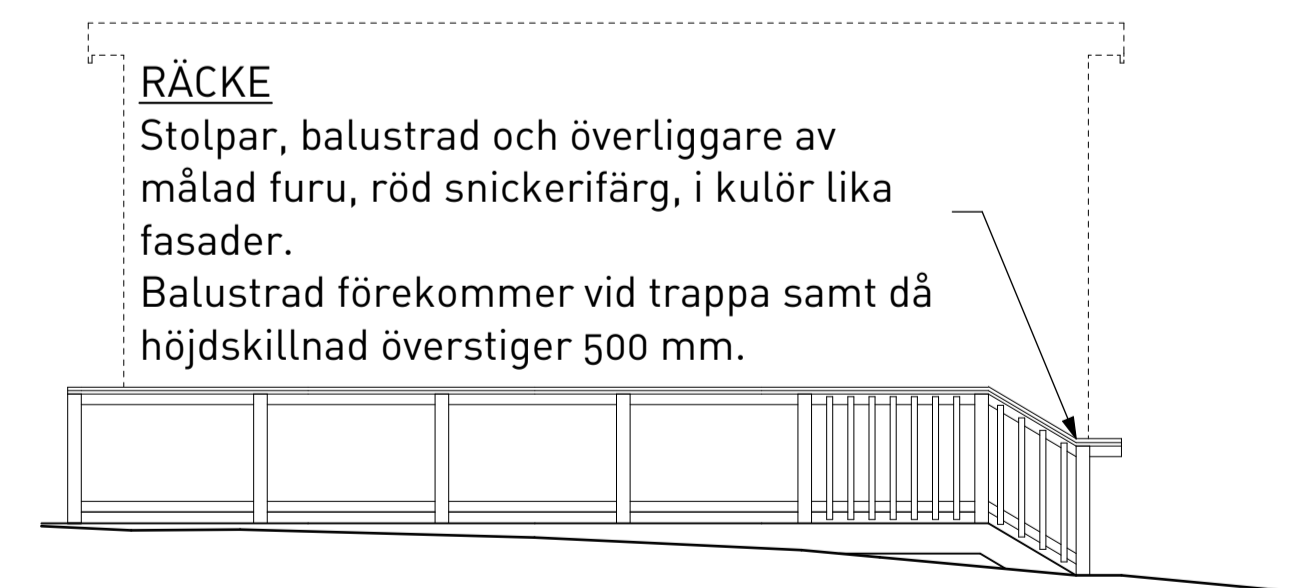
VY MOT SYDÖST Nytt räcke
