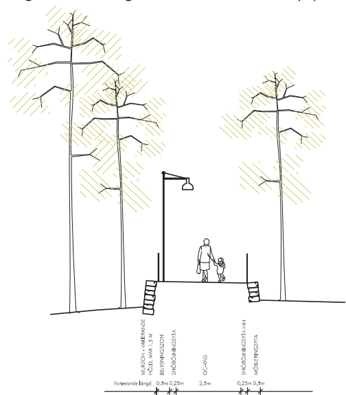
Sektion uppbyggd gc-väg över mark. Skala 1:200.
