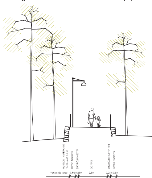
Sektion uppbyggd gc-väg över mark. Skala 1:200.
