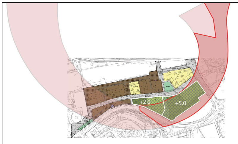
Figur 22. Översiktlig bild där Trafikverkets redovisade område för Östlig förbindelses ramper illustreras med röd färg. Inom mörkröd yta med röd kantlinje planeras eventuella framtida tunnlar ligga närmare markytan än 25 meter. Gröna ytor med raster illustrerar det område som omfattas av schaktdjupsbegränsning till nivåerna +2,0 och +5,0.
