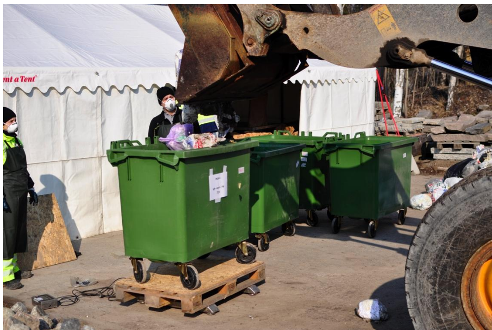
Figur 3 Vägning och ilastning av delprov i kärl.
