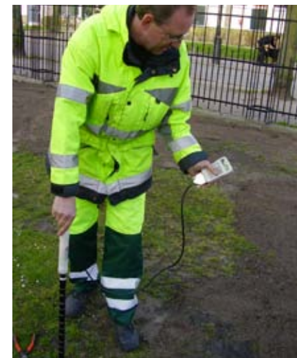
Bevattning är en central del av etableringsprocessen för träd. Här mäts fuktigheten i mark med elektronisk utrustning vid nyplanterade träd i vegetationsyta. (Foto: Örjan Stål)
