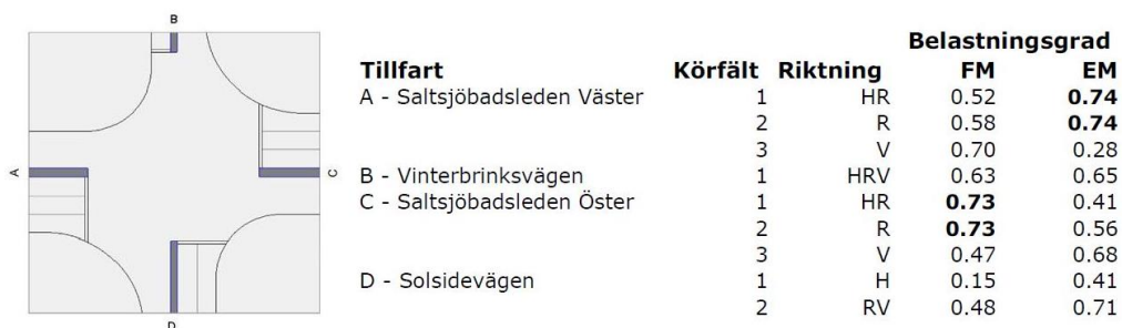
Figur 22 Saltsjöbadsleden-Solsidev./Vinterbrinksv, signal utan högersvängfält.
