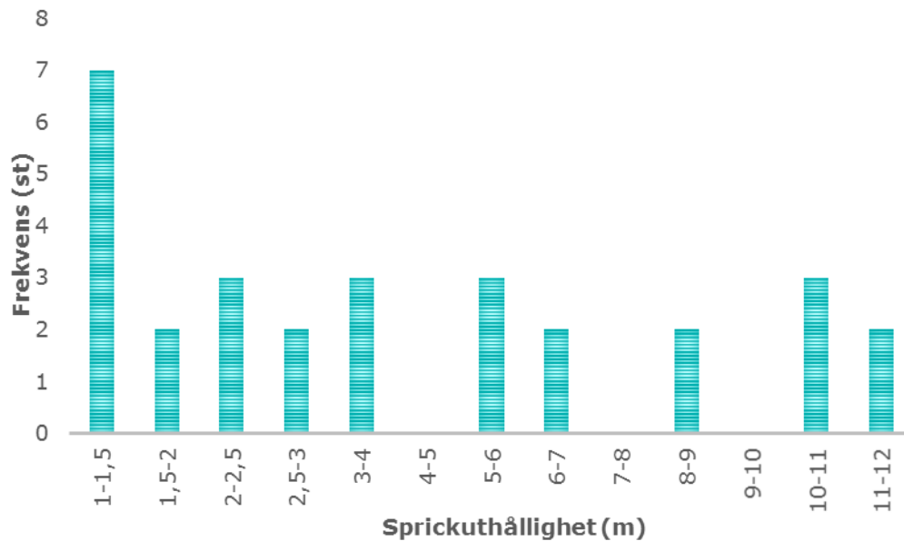
Figur 8. Histogram över sprickornas uthållighet dvs. observerad längd.
