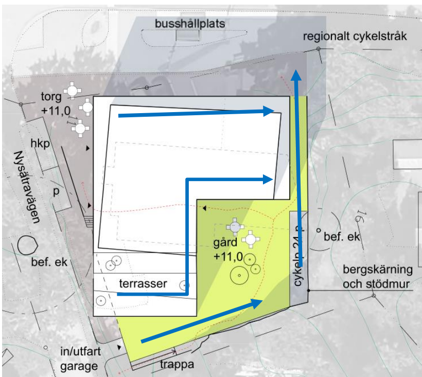
Figur 18 – Förslag på avrinningsvägar för hus och innergård
