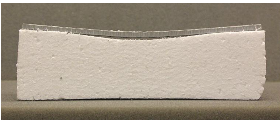
Bild 4. Typisk skada efter slagprovning
