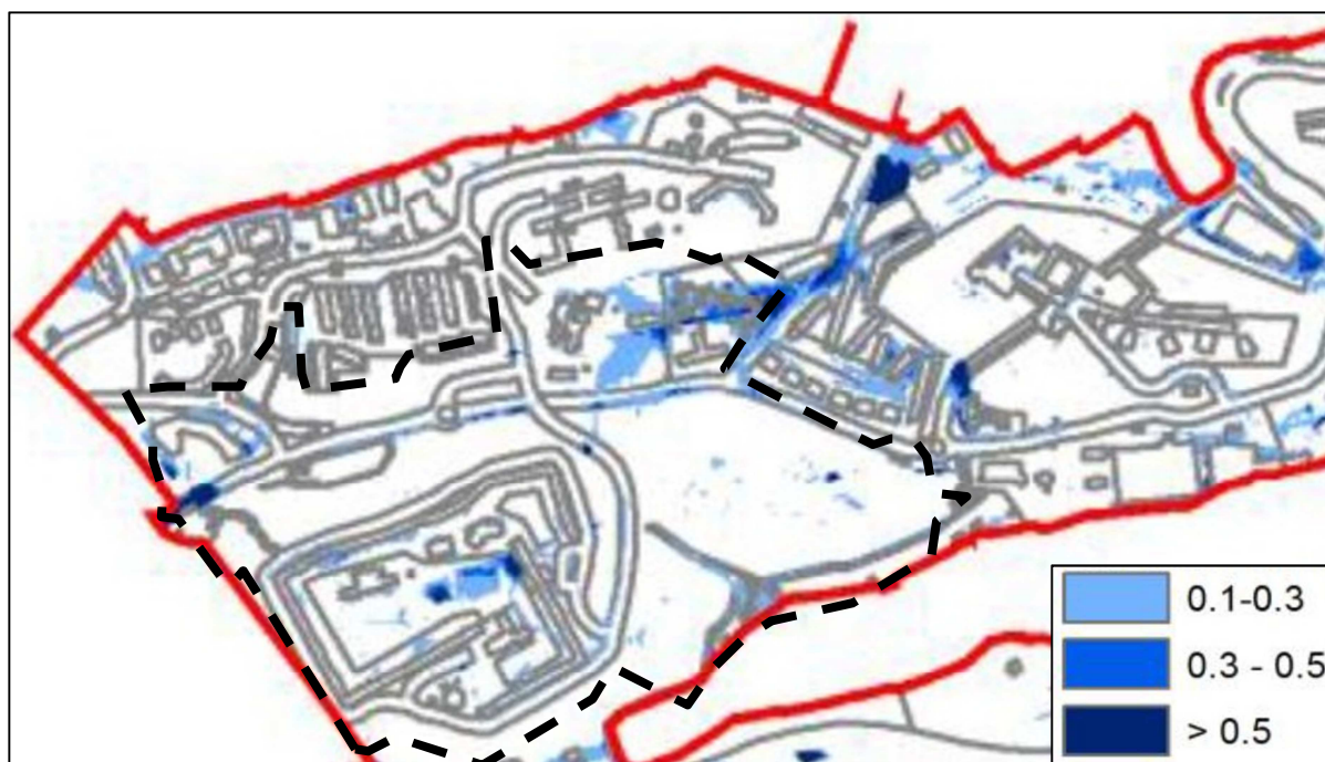
Figur 3-4. Skyfallsanalys med beräknat maximalt översvämningsdjup (m) i samband med ett återkommande 100-årsregn med klimatfaktor 1,2 (Nacka kommun, 2014). Svartstreckad polygon visar utredningsområdets ungefärliga avgränsning.
