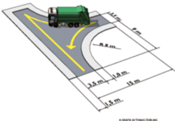
Figur 4-1 Principskiss på vändning av sopbil.
