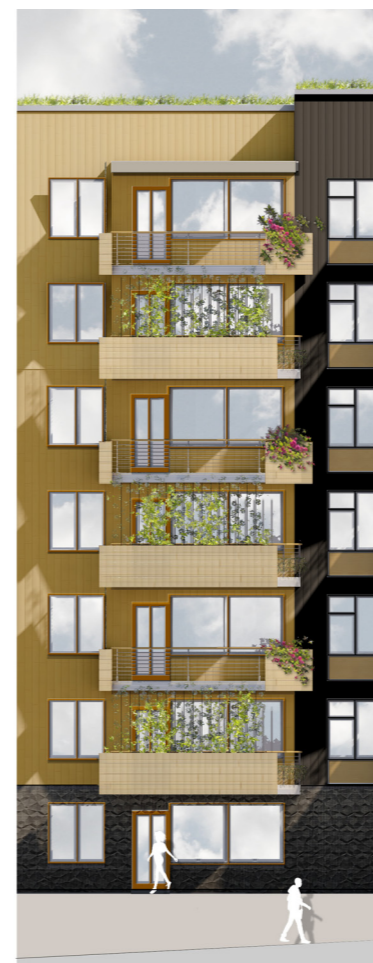
Fasadutsnitt mot väster Balkongerna här har fasta planteringslådor i framkant eller sida, samt raster där växterna i dessa kan klättra. Detta för att åstadkomma en grönskande varierande fasad .
