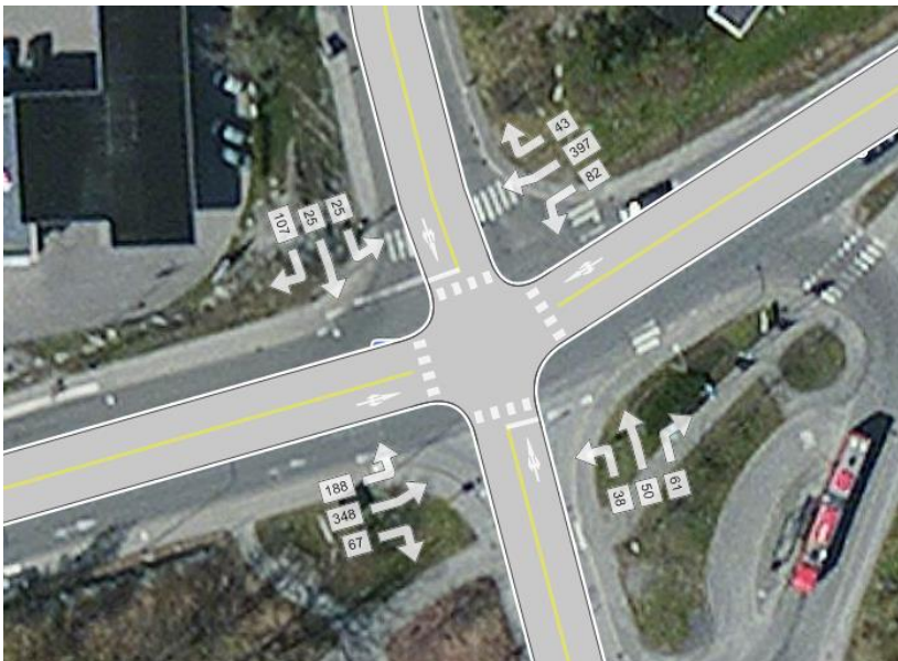
Figur 15. Prognostiserade trafikflöden i K2 (Ältavägen/Oxelvägen/Ältabergsvägen) under eftermiddagens maxtimme. Samma trafikflöden gäller även i UA3 där korsningen utformas som cirkulationsplats.
