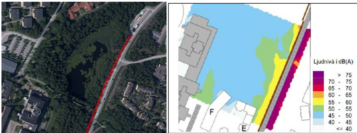
Figur 4. Bullerskyddsskärmens utsträckning samt ekvivalent ljudnivå från vägtrafik, 1,5 meter över mark med 2 meter hög skärm.
