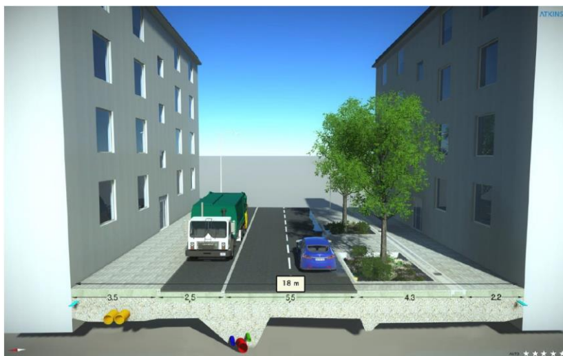
Figur 17. Gatusektion från Nacka stads gatustandard på 18 meter med enkelsidig trädrad och öppna regnbäddar.
