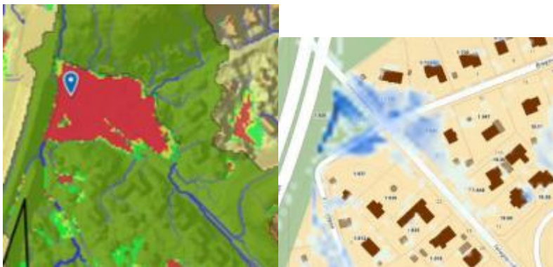
Figur 20 och 21: Den vänstra bilden visar lågpunkt (rödmarkerad) norr om verksamhetsområdet. Den högra bilden visar samma lågpunkt (blåmarkerad) från kommunens skyfallsanalys samt befintliga byggnader.
