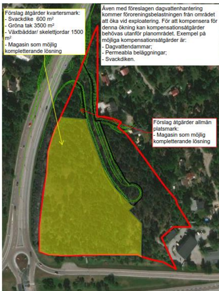
Figur 10 - Föreslagna dagvattenåtgärder. Placeringen av dessa behöver ses över när en illustrationsplan med höjder är framtagen. Se text nedan för en närmare beskrivning av varje lösningsförslag. Förslag på kvartersmark markerat med gult, allmän platsmark övriga ytor inom planområdet (röd linje).
