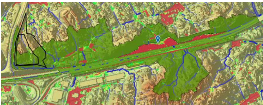
Figur 18. Tillrinningsområde (grönmarkerat) till den östliga lågpunkten längs Värmdöleden (väg 222).
