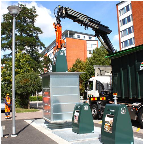
Figur 2. Exempel på underjordsbehållare som töms med kranbil. Foto: SanSac.
