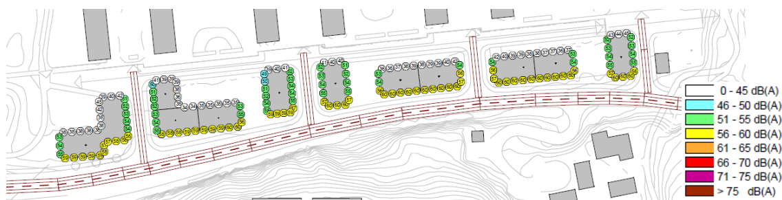
Figur 3. Figuren visar ekvivalent ljudnivå vid fasad med det högsta värde oavsett våningsplan. Vägtrafikens prognos är för år 2040.
