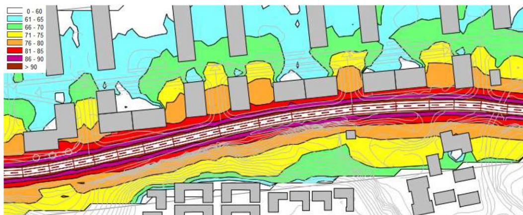
Figur 4. Ljudutbredning 1,5 meter ovan mark vid mark vid maximal ljudnivå L_{AFmax} (dBA) från trafik. Gröna, blåa och vita gårdsytor uppfyller bullerkrav.
