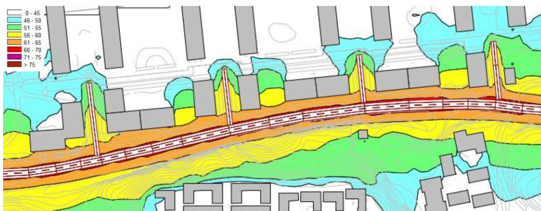
Figur 5. Ljudutbredning 1,5 meter ovan mark vid mark vid ekvivalent ljudnivå L_{Aeq} (dBA) från trafik. Blåa och vita gårdsytor uppfyller bullerkrav.
